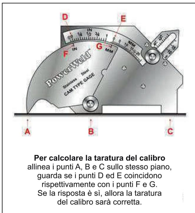
**Per calcolare la taratura del calibro** allinea i punti A, B e C sullo stesso piano, guarda se i punti D ed E coincidono rispettivamente con i punti F e G. Se la risposta è sì, allora la taratura del calibro sarà corretta.
