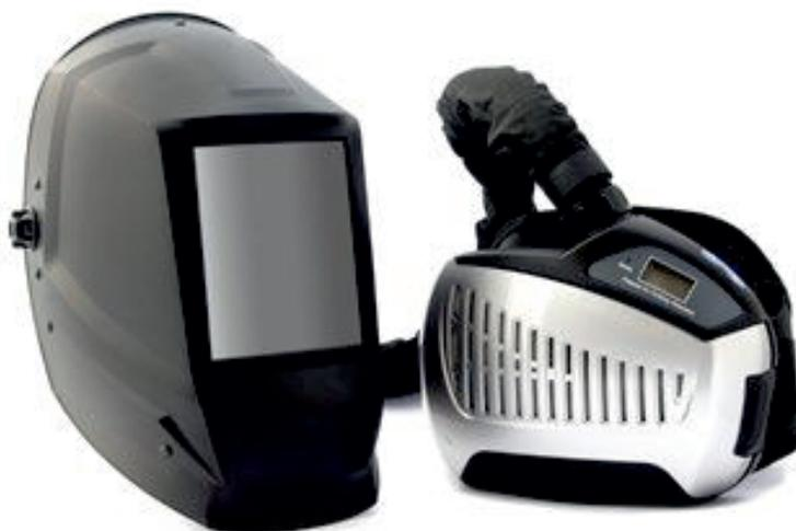
Sistema PAPR per saldatura con unità di filtraggio in classe Th2 con un grado di efficienza del 95%. Equipaggiato con una maschera a cristalli liquidi a 4 sensori con grado di oscuramento variabile e regolabile su due scale: 5-9 e 9-13 DIN con funzione di molatura.
