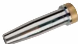
Punta da taglio ACETILENE, due pezzi, con testa piana. Interno realizzato in ottone ed esterno in rame nichelato. Per lancia da taglio **TT2** e cannello **SIDERJET**.
